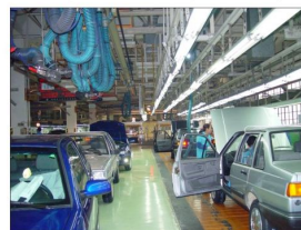
上海大众二厂 （半自动滑轨式软管尾气抽排系统） SVW CP2 ( Half-Automatic oval System with conveyor)
